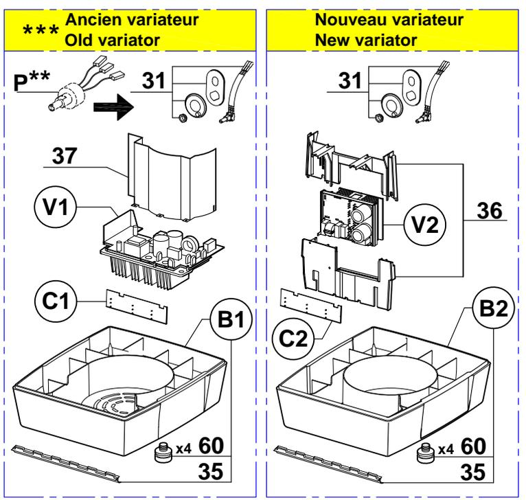
\*\* L'ancien potentiomètre P est remplacé par l'ensemble 31.
