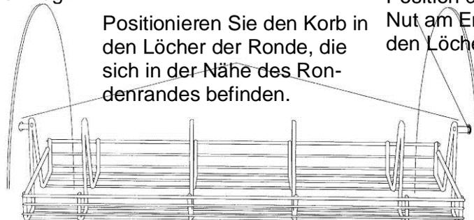
Positionieren Sie den Korb in den Löchern der Ronde, die sich in der Nähe des Rondenrandes befinden.
