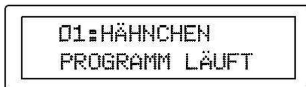
Im Programmiermodus werden in der ersten Zeile der Klarschrift-Anzeige der Programmplatz und Name angezeigt. In der zweiten Zeile werden die Auswahl von Funktionen und die Eingabe von Werten über den Drehgeber (5.2.17) angefordert.
