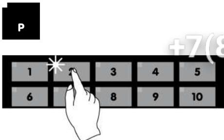
1. Нажмите кнопку ПРОГРАММИРОВАНИЕ P. Светодиод мигает, система управления переходит в режим программирования.
