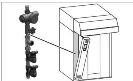
Система водоснабжения требуется для создания пара в пекарной камере. Система водоснабжения хлебопекарной печи находится за панелью управления и во время УСТАНОВКИ печи присоединяется специалистами-сантехниками к водоподающей линии, предоставляемой владельцем.
