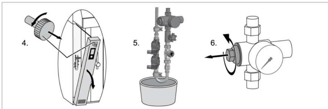
4. Ослабьте в винт с накатанной головкой и отклоните панель управления.
