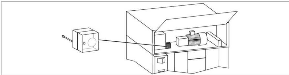
Реле перепада давления контролирует давление в пекарной камере.
