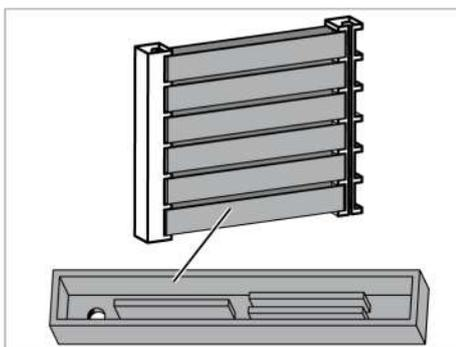
В зависимости от программы выпечки через предварительно установленный промежуток времени по горячим желобам пароувлажнителя подается вода, которая превращается в пар. Через рейку с отверстиями пар попадает в пекарную камеру и оседает на выпекаемые изделия.
