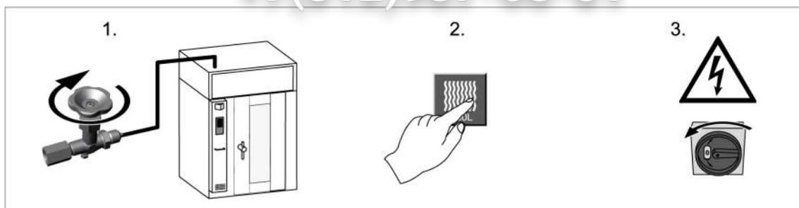
1. Закройте предоставляемый владельцем запорный вентиль на водоподающей линии.
