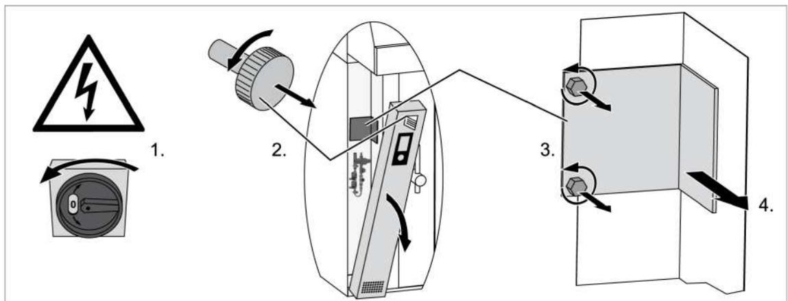
1. Отсоедините установку от источника электропитания и исключите возможность ее повторного включения.
