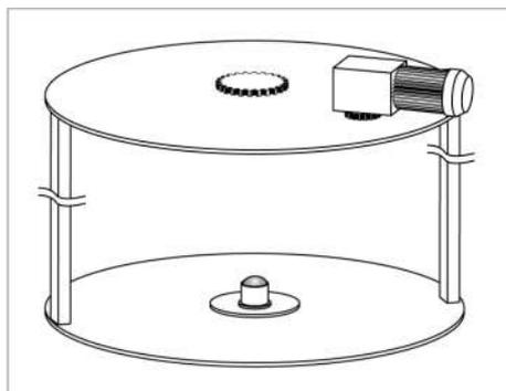
Поворотная плита служит для крепления стеллажной тележки.
