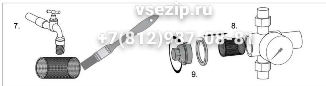
7. Извлеките фильтровальную сетку и очистите ее под струей проточной воды. При необходимости используйте кисточку. Если требуется, замените фильтровальную сетку.
