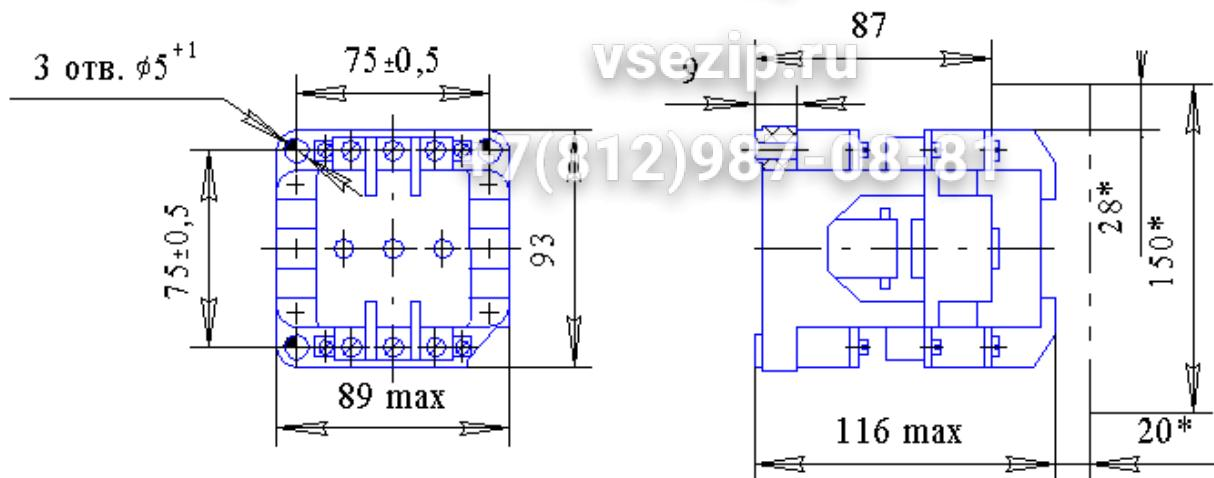
Рис. 2.64 - Пускатели нереверсивные без реле типа ПМЕ-211, ПМА-3100
