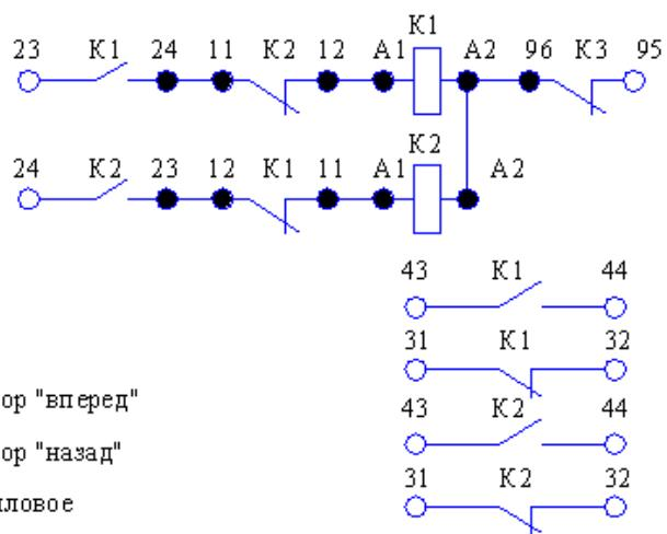
Рис. 2.75 - Пускатели реверсивные с реле типа ПМЕ-214 и ПМА-3400
