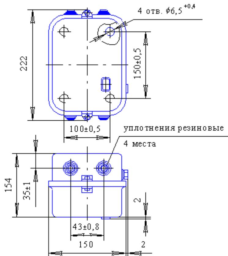
Рис. 2.71 - Пускатели электромагнитные типа ПМА-3110, ПМА-3210
