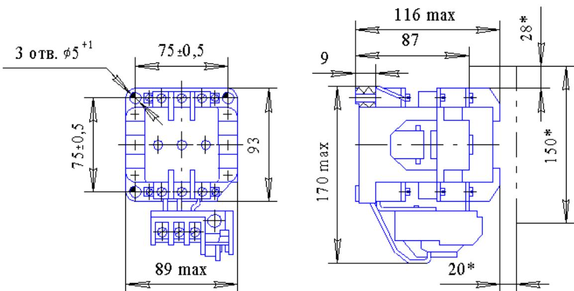
Рис. 2.65 - Пускатели нереверсивные с реле типа ПМЕ-212
