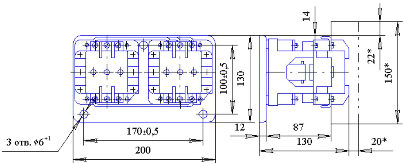
Рис. 2.66 – Пускатели реверсивные без реле типа ПМЕ-213, ПМА-3300
