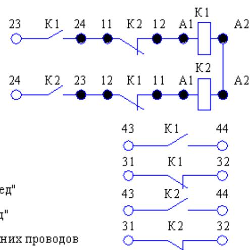
Рис. 2.74 - Пускатели реверсивные без реле типа ПМЕ-213 и ПМА-3300
