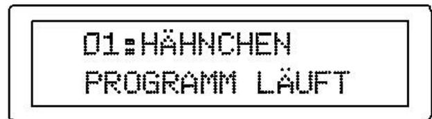
Im Programmiermodus werden in der ersten Zeile der Klarschrift-Anzeige der Programmplatz und Name angezeigt. In der zweiten Zeile werden die Auswahl von Funktionen und die Eingabe von Werten über den Drehgeber (5.2.17) angefordert.
