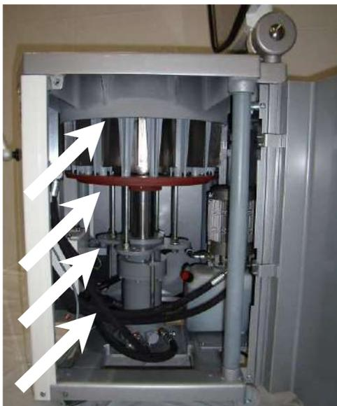
Пропылесосьте все внутренние части машины, особенно углы, где может накапливаться тесто и мука, а также механические части (см. схему).
