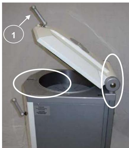
При открытии крышки, существует риск защемления тела крышкой (позади машины). Эта зона недоступна при правильном использовании. При закрытии крышки единственной частью машины, находящейся в контакте с вами должна быть ручка (1) открытия и закрытия крышки.
