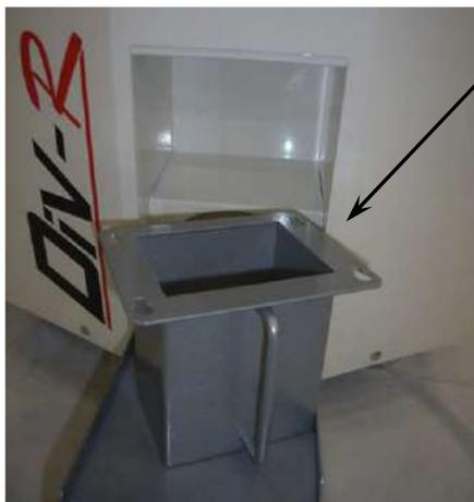
Бак размещен точно над регулировкой давления для подбора излишков муки из системы анти-выброса. При нормальной эксплуатации машины, этот бак необходимо очищать каждую неделю.
