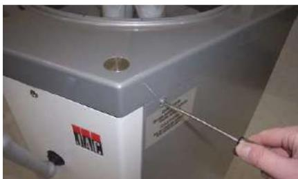
При помощи отвертки, выверните два винта с каждой стороны тестоделителя:
