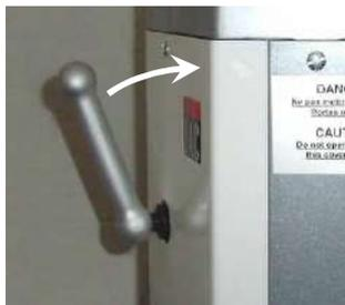
При повороте рычага управления к машине происходит опускание головки для высвобождения изделий.
