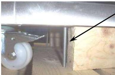
После снятия упаковки, снимите машину с поддона, сняв транспортные болты, установите машину прямо на поверхности, предварительно заблокировав оба тормоза на передних колесах. При выполнении этой операции, опрокидывать тестоделитель не допускается.
