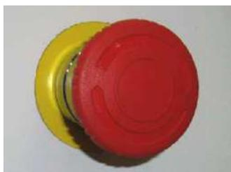
Чтобы обеспечить работу машины после экстренного отключения, вы должны повернуть красную ручку по направлению стрелки и реактивировать рычаг управления. Перед последующим пуском необходимо убедиться, что опасность, которая потребовала применения экстренного отключения, отсутствует.
