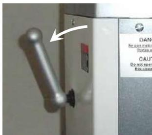
При установлении рычага управления в положение к себе происходит поднятие головки для осуществления операции деления теста.
