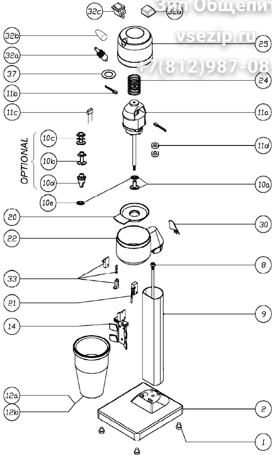
Attenzione: se dovete cambiare il supporto bicchiere frullino su apparecchi acquistati prima di settembre '99 che non hanno l'interruttore (32) sulla capottina, dovete acquistare il supporto (14) + la testata (22) e cambiarli entrambi. L'esatto n° del pezzo di ricambio è 14b.
